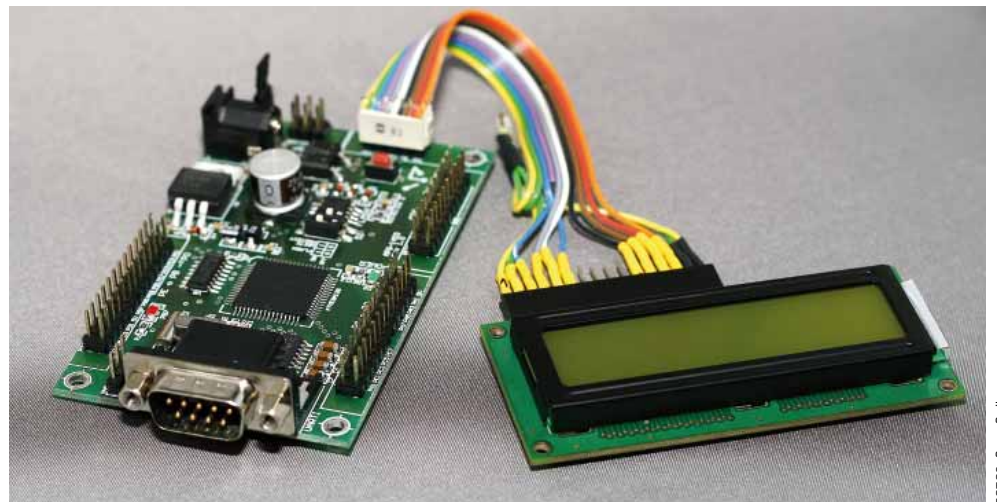
Herzstück des Homelab bildet ein ATmega128-Board, welches von der ITTGroup, einem estnischen Partner realisiert wurde.
